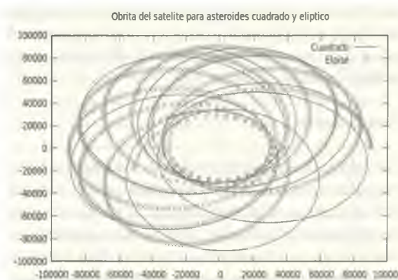
Figura 13: Órbita para v_{oy}=20000 m/s, para forma elíptica y cuadrada.
