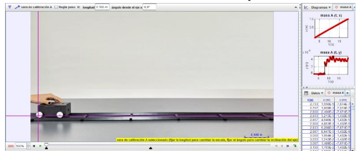
Figura 2 Análisis en Tracker de un movimiento con rapidez constante
