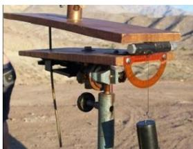
Figura 9. Plataforma ecuatorial de brazo simple con motor.
