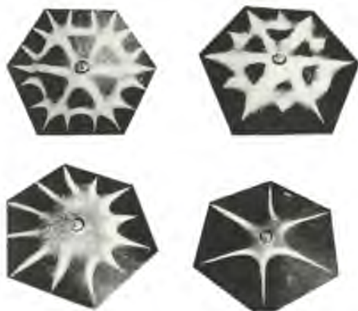
Fig. 8. Diagramas obtenidos en una placa hexagonal con frecuencias crecientes.
