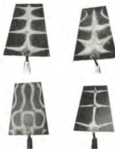
Fig. 9. Diagramas obtenidos en una espátula con frecuencias crecientes.
