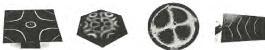
Fig. 6. Figuras de Chladni obtenidas con placas de distinta geometría
