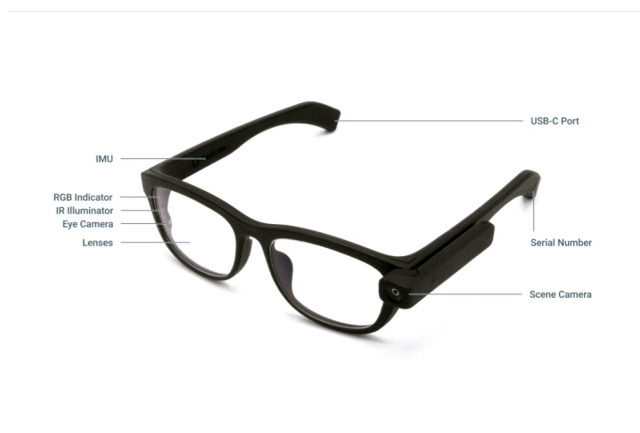
Figura 1. Componentes dos óculos Pupil Invisible da empresa Pupil Labs
